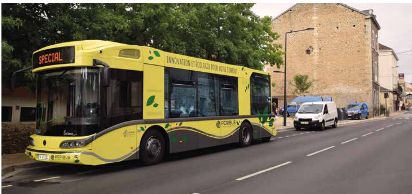
Businova, l'autobus électrique hybride rechargeable se démarque grâce à deux innovations majeures, la motorisation et l'architecture
